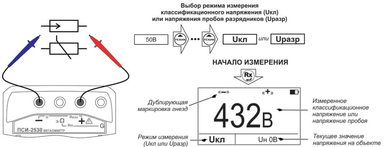
Рисунок 2.10 – Измерение классификационного напряжения или напряжения пробоя разрядников
